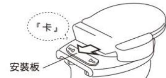
◎ 本體拆卸時，請按壓拆卸鈕，並同時將本體向前拉出卸下。
