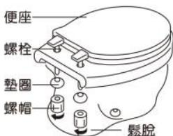
**2** 確認安裝位置時，先暫時放上製品，之後再確認製品前緣與馬桶前端對齊後，在製品後端畫上輔助線。
