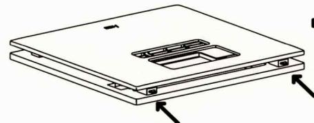
②使用M4X8的十字不鏽鋼螺釘，將面板框固定於主機上。
